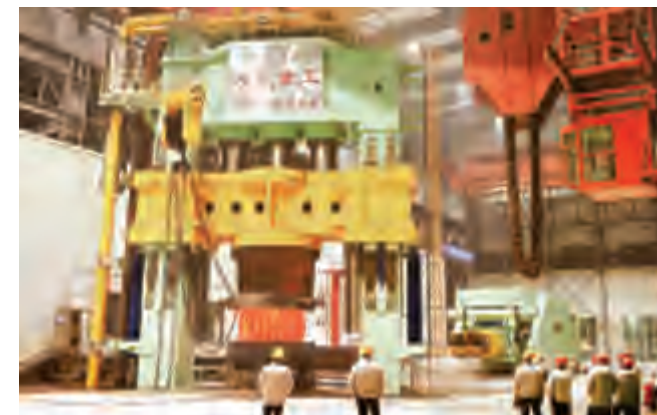
125MN 锻造液压机 125MN Forging Press
