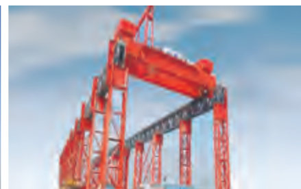
350t+350t-43m 双小车桥机 350t+350t-43m Overhead Crane
