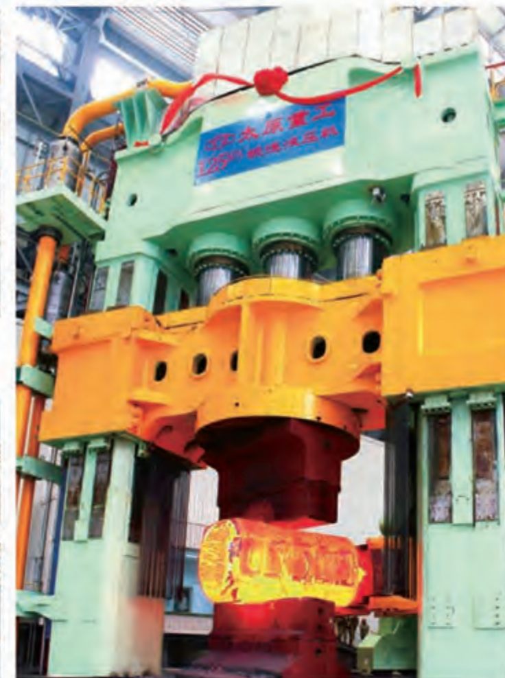
125MN自由锻造液压机 125MN Open Die Forging Hydraulic Press
